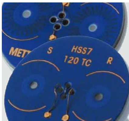
Rys 5. Płyta ceramiczna z wbudowanym sensorem
